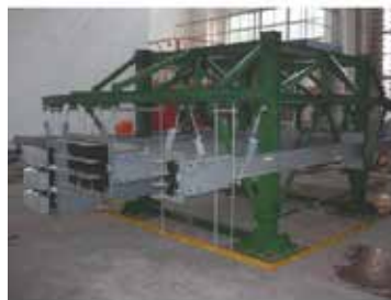
Горизонтальные испытания на сейсмическую стойкость
