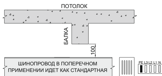
РИСУНОК 4 - ПЕРЕСЕЧЕНИЕ ПОД БАЛКОЙ А В ПОПЕРЕЧНОМ ПРИМЕНЕНИИ
